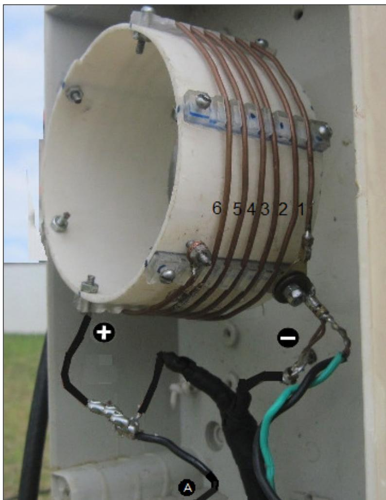
Fig. 5: O hairpin já no interior da caixa de proteção. Observe os espaçadores de acrílico, as inserções do condutor central (+) e da malha (-) do coaxial, a saída para o fio vertical da antena (A) e a numeração das espiras.
