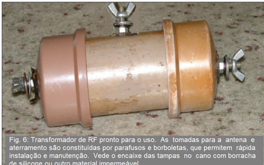
Fig. 6: Transformador de RF pronto para o uso. As tomadas para a antena e aterramento são constituídas por parafusos e borboletas, que permitem rápida instalação e manutenção. Vede o encaixe das tampas no cano com borracha de silicone ou outro material impermeável.
