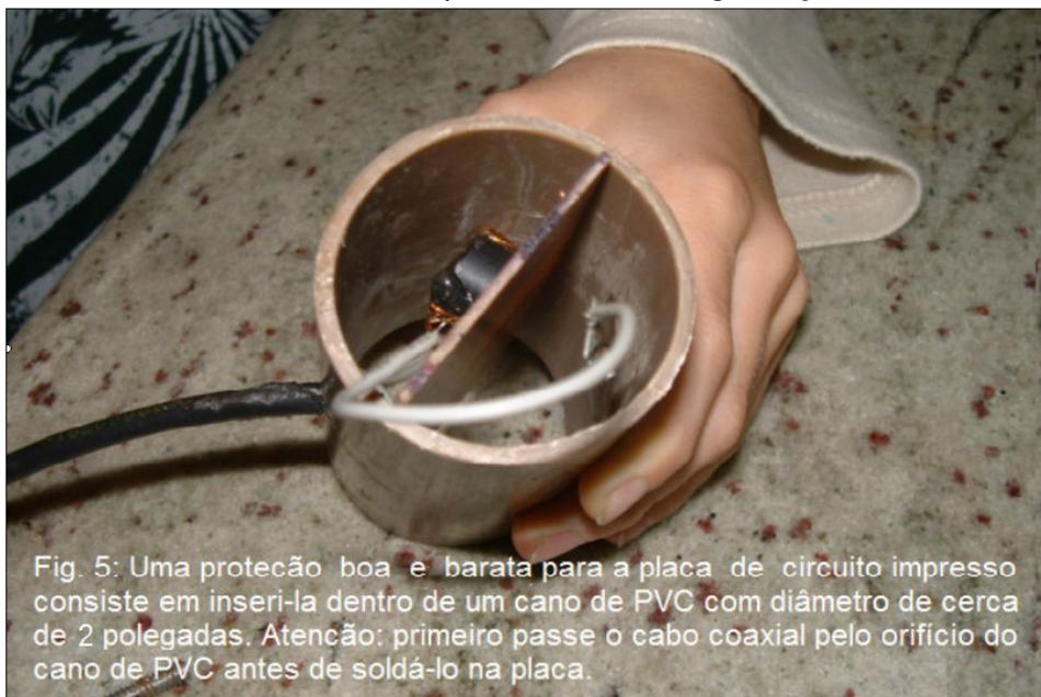
Fig. 5: Uma proteção boa e barata para a placa de circuito impresso consiste em inseri-la dentro de um cano de PVC com diâmetro de cerca de 2 polegadas. Atenção: primeiro passe o cabo coaxial pelo orifício do cano de PVC antes de soldá-lo na placa.
