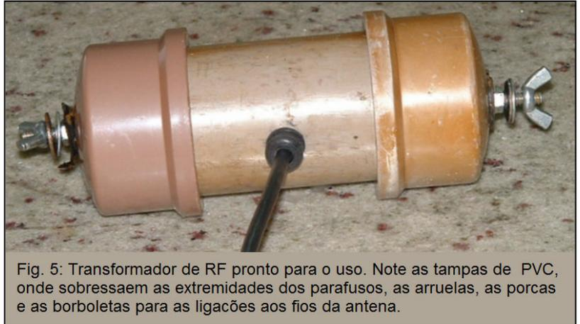
Fig. 5: Transformador de RF pronto para o uso. Note as tampas de PVC, onde sobressaem as extremidades dos parafusos, as arruelas, as porcas e as borboletas para as ligações aos fios da antena.
