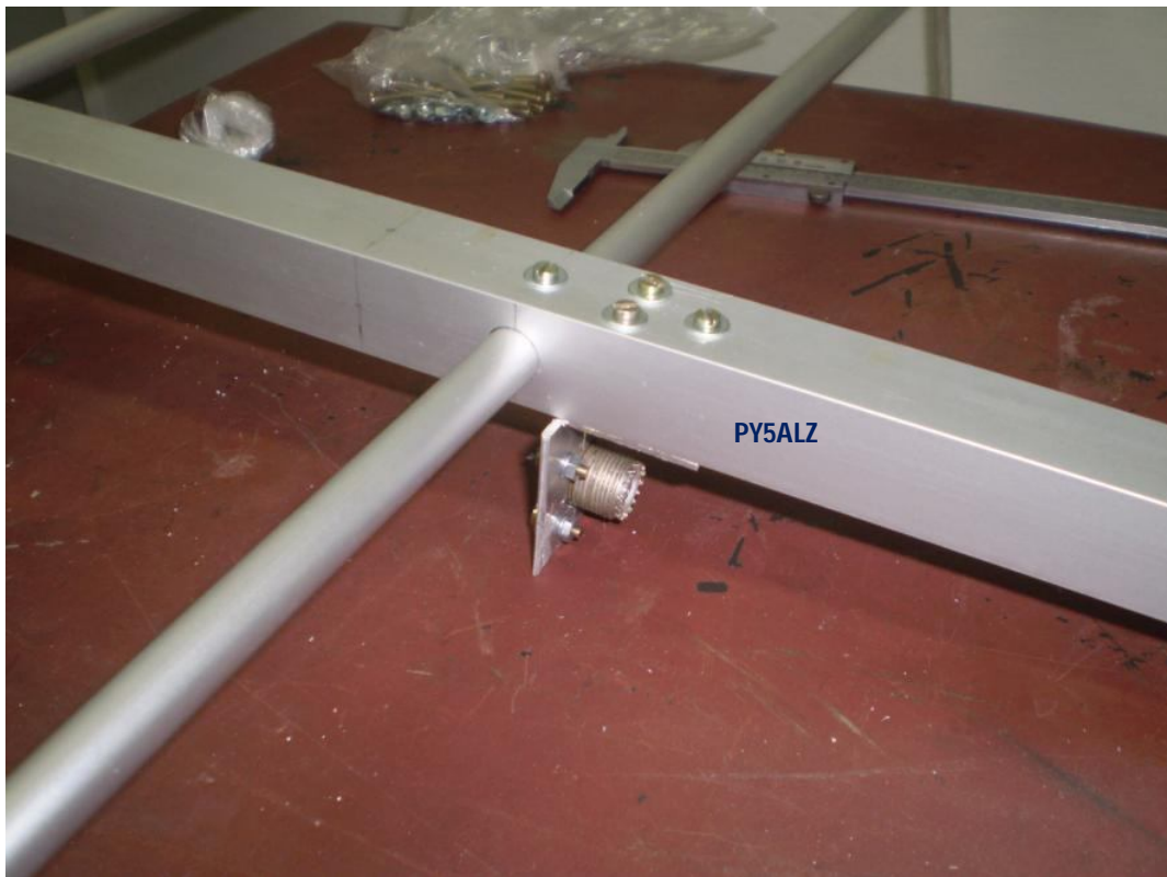
Fig15.: Detalhe do elemento e suporte fixados na gôndola
