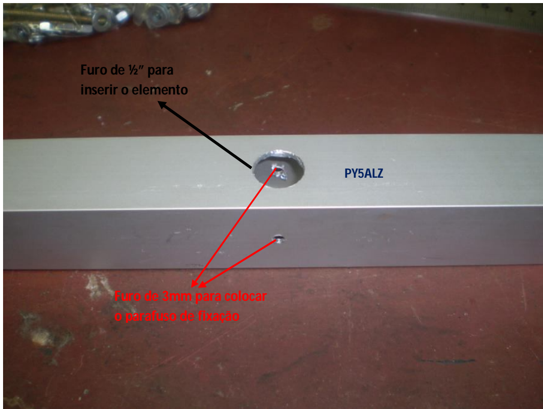
Fig7.: Furos para o elemento e para o parafuso
