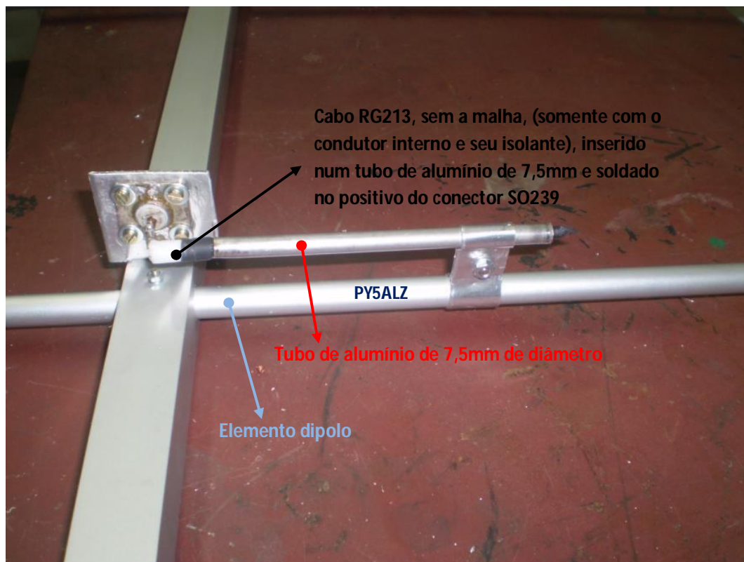
Fig16.: Detalhe da construção e montagem do gamma match
