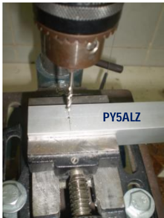
Fig5.: O furo deve atravessar todo o perfil.
