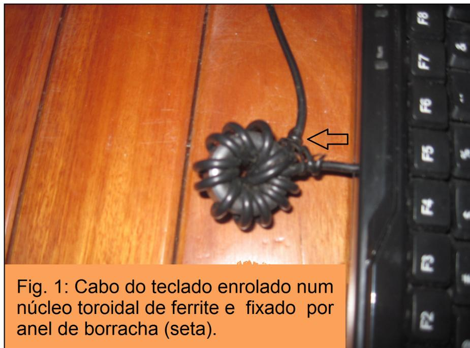
Fig. 1: Cabo do teclado enrolado num núcleo toroidal de ferrite e fixado por anel de borracha (seta).
